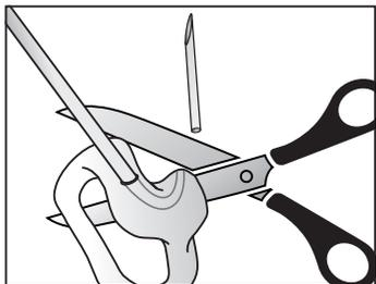
5. 从尽可能紧贴耳模的位置剪掉尖端。确保导音管没有露出粗糙的边缘，否则会刺激耳朵。
