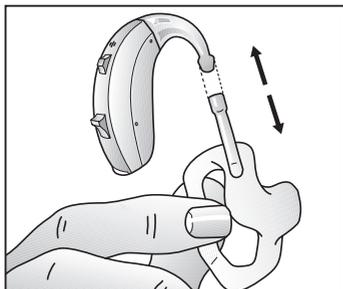
1. 从助听器上取下耳模，然后从耳模上拔出导音管。
