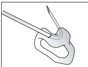
4. 将导音管的尖端拉过耳模，直至导音管的另一端垂直紧贴耳模。
