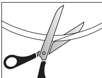
2. 将导音管预弯部分的后 5 厘米斜剪成锥形尖端。
