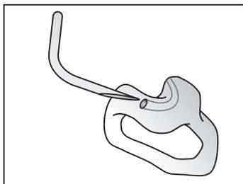
3. 如图所示，将尖端从外侧插入耳模上的通道，直至从另一端穿出来。如果您的耳模上有两个洞，将导音管从顶部较大的洞中穿过。
