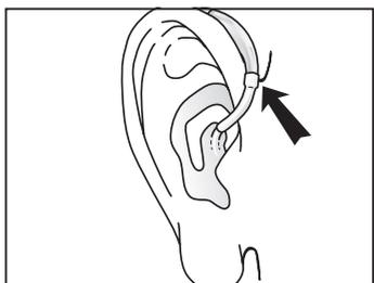
6. 现在调整导音管的长度以适合您的耳朵。对比之前取下的旧导音管长度剪断新安装的导音管。或者将助听器戴到耳朵上，在其穿过助听器的位置做上标记（如图所示），然后剪断。
