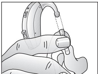
7. 要将助听器重新安装到耳模上，请挤压导音管的顶部，然后将耳模和助听器装到一起。
