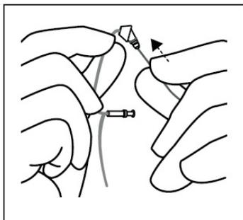
5. 最后，将细声管推回到助听器上，直到它牢固地咔咔作响。
