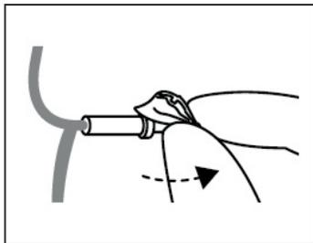
4. 小心地抬起耳塞的下部，检查耳塞是否安全并验证项圈是否完全覆盖细声管的棱状末端。
