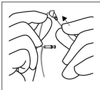
2. 现在，将清洁线穿过连接助听器的声管顶部。将清洁线完全穿过清除碎片。
