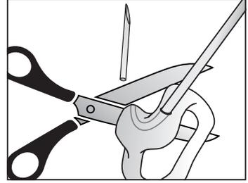
٦- يلزم الآن ضبط طول الأنبوب ليناسب أذنك. ضع قطعة الأنبوب القديمة (التي أزلتها سابقًا) في محاذاة الأنبوب الجديد الذي تثبته ثم قس الطول وقُص، أو ضع جهاز المساعدة السمعية فوق أذنك، وحدد النقطة التي يعبر فيها الأنبوب جهاز المساعدة السمعية على النحو الموضح بالشكل، ثم قُص.
